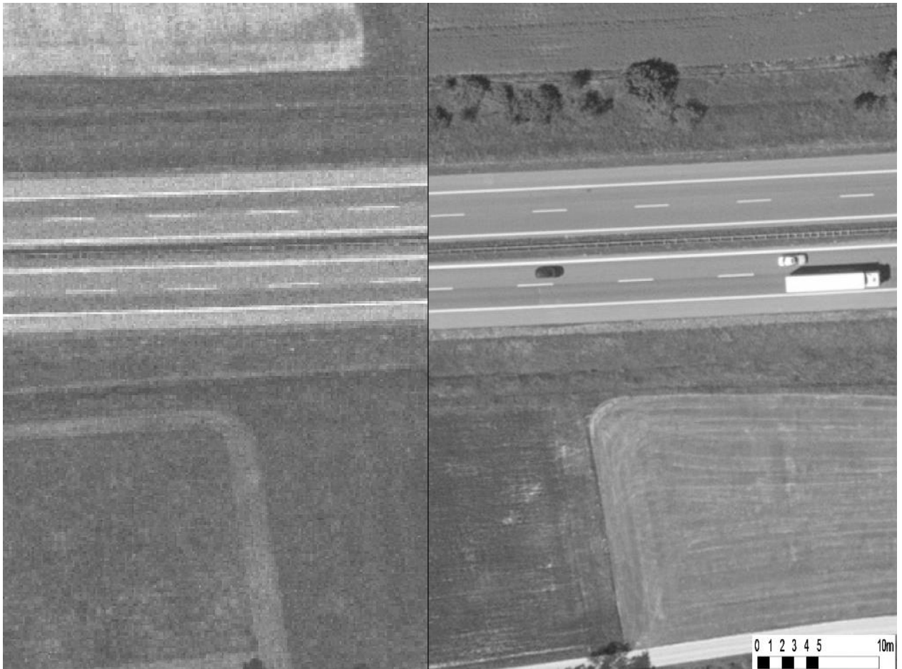
Abbildung 18: Verschiebung der Autobahn des berechneten Orthophotos (links) zum tatsächlichen Ort (rechts)
